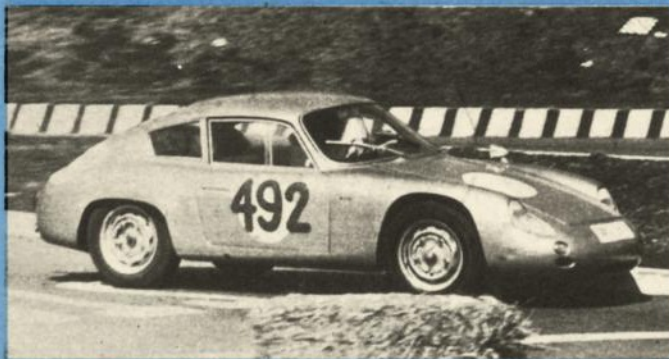
La « Carrera » con carrozzeria Abarth venne costruita in piccola serie (20 unità) nel 1960. Aveva il classico motore 4 cilindri bialbero di 1,6 litri con potenza da 115 CV a 6500 giri/min a 136 CV a 7400 giri/min. Peso 860 kg. Velocità 210-220 km/h.
