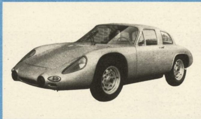
La Carrera « 2000 GS-GT » del 1963: decisamente da competizione ottenne numerose affermazioni contro vetture di maggior cilindrata. Motore sempre a 4 cilindri bialbero di 1966 cc. Potenza di 155 CV DIN a 6600 giri/min.
