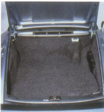
Il bagagliaio anteriore della "Turbo"; la ruota di scorta è alloggiata orizzontalmente sotto il piano di carico.
