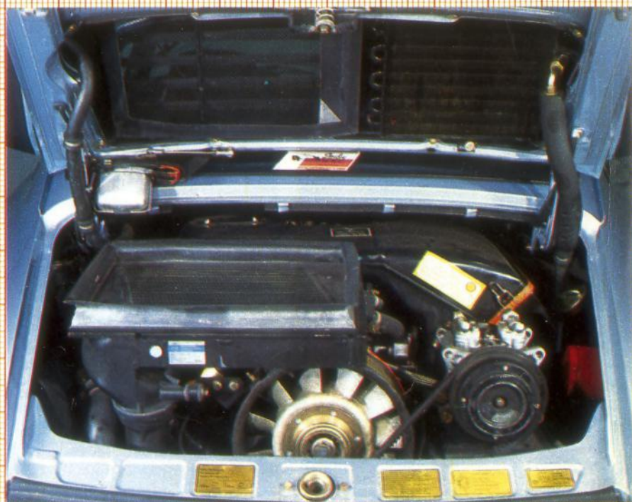
Il vano motore della Porsche "Turbo": in primo piano la ventola di raffreddamento, coassiale con l'alternatore, mossa da cinghie e, sulla destra il compressore dell'impianto di condizionamento (il condensatore è sul coperchio del cofano entro l'alettone). Il radiatore a sinistra (intercooler) raffredda l'aria compressa di alimentazione.
